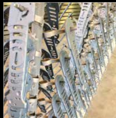
Preparing BF2V handles for the anodization process Preparazione all'anodizzazione di impugnature BF2V
