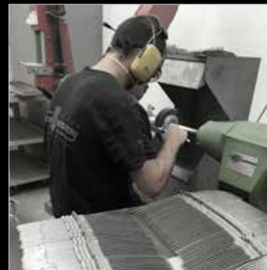
Handmade finishing process of COL MOSCHIN blade Operazione di finitura manuale su lama COL MOSCHIN
