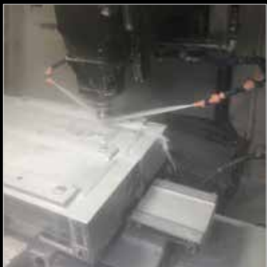
CNC processing of BF1 handle Lavorazione CNC impugnatura BF1
