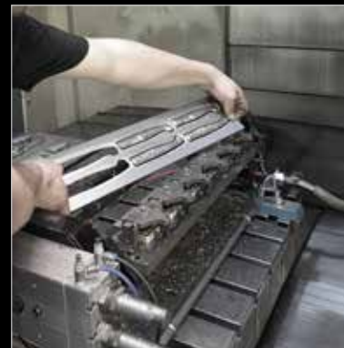
CNC processing of RESOLZA knives Lavorazione CNC di modello RESOLZA
