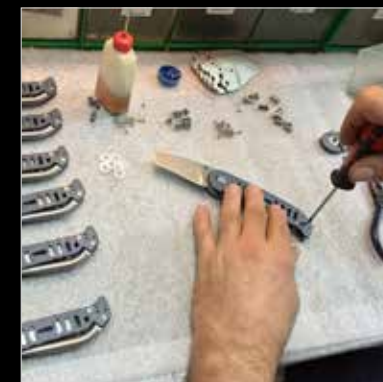
Assembling and setting of BF2 V Fase di assemblaggio e registrazione su BF2 V
