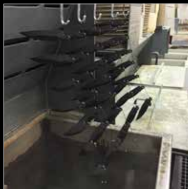
Interim phase of the oxidation process for RESOLZA blade Fase intermedia di ossidazione su lama RESOLZA
